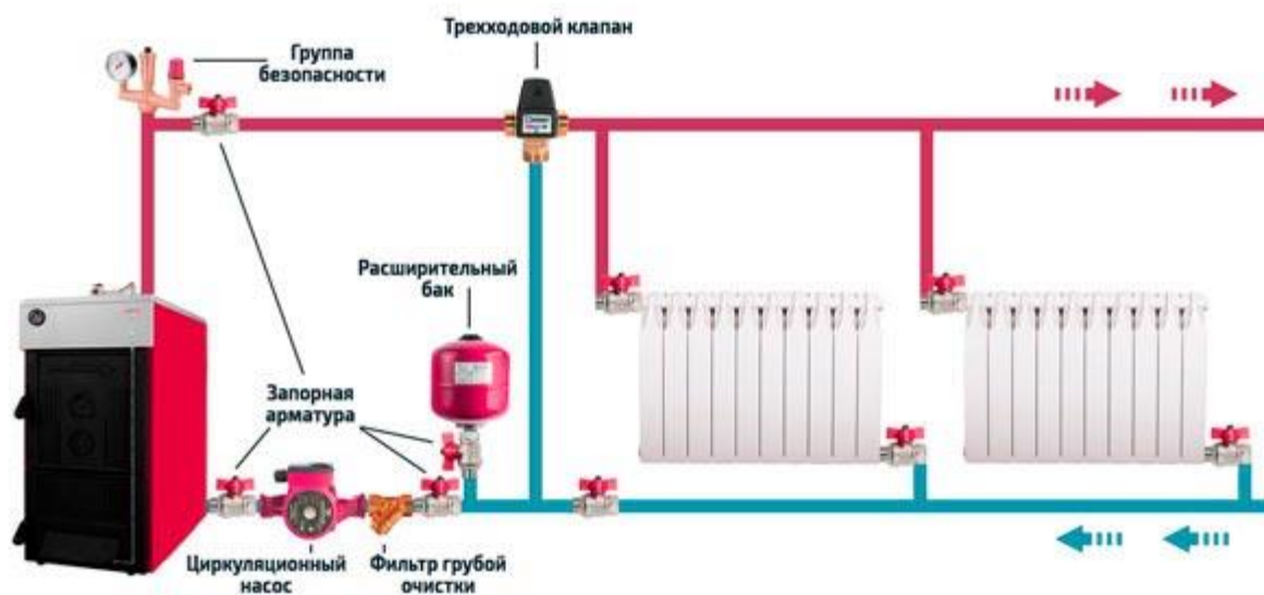
Схема без бойлера косвенного нагрева
